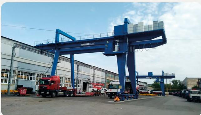
Кран мостовой опорный грузоподъемностью 5,0 тонн в комплекте с эстакадой длиной 72,0 метра для предприятия в г. Москва.
