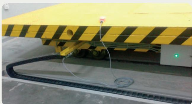
двухмерного, трёхмерного перемещения подвижных частей оборудования. Может использоваться для эксплуатации как в помещении, так и на улице. Применим для токоподвода на грузоподъёмных машинах и механизмах, тележках, кантователях и т.д.
